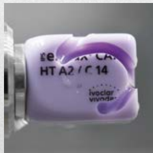
Im „Carving Mode“ wird überschüssiges Material im Ganzen abgetrennt
