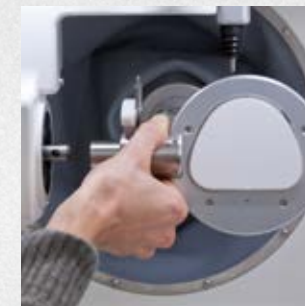
Einfacher Wechsel des Rohlingshalters zur Umstellung von Fräsen auf Schleifen
