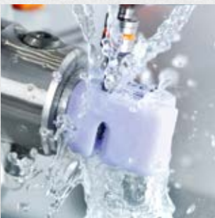
Im „Carving Mode“ wird überschüssiges Material im Ganzen abgetrennt
