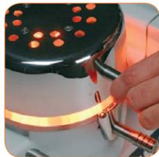
Kurzweiliger, thermostatisch gesteuerter IR-Strahler, die Arbeitstemperatur wird ohne Wartezeit in nur 1 Sek. erreicht. Schwenken des Strahlers über die Folie aktiviert unmittelbar die Beheizung.
